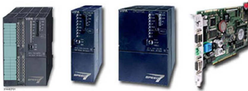
Módulos do System 300V podem ser utilizados com CPUs SPEED7
